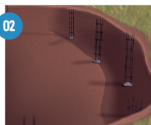
02 Escavação da piscina e confecção de brocas e colunas;
